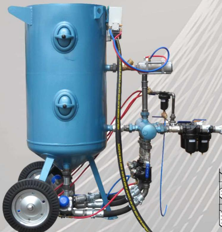
Grenailleuse de capacité 300 litres double corps pour un travail en continu à plusieurs opérateurs simultanément.
